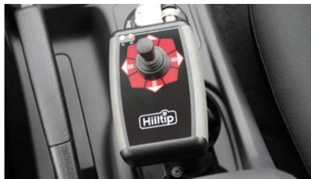
PÁKOVÝ OVLÁDAČ PLUHU - pákový ovládač vo vnútri kabíny s jednoduchým používaním pre jednoduché ovládanie snežného pluhu. (len elektrohydraulika)
