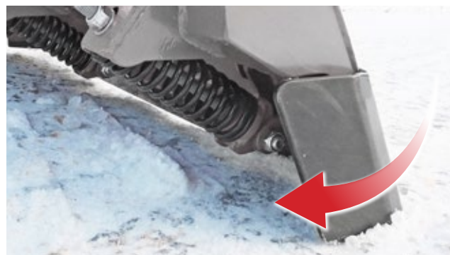
REZNÁ HRANA so zarážkovými (trip) pružinami chráni pluh a vozidlo pri nárazoch do prekážok.
