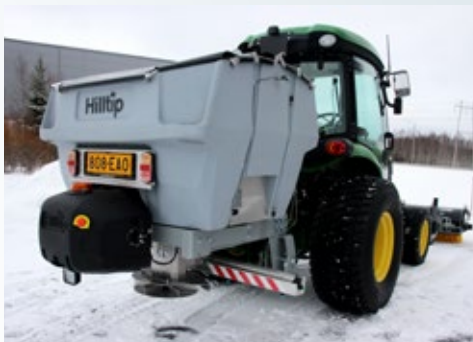
Rozmetadlo s 3-bodovým závesom a voliteľnou rozprašovacou lištou.
